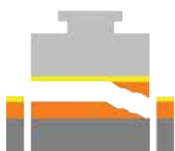
Fallo parcial de revestimiento
