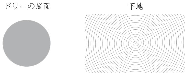
c) 接着剤層剥離
